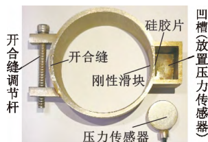
图 1 可开合环刀及压力传感器 Fig. 1 Retractable Cutting Ring and Pressure Sensor
